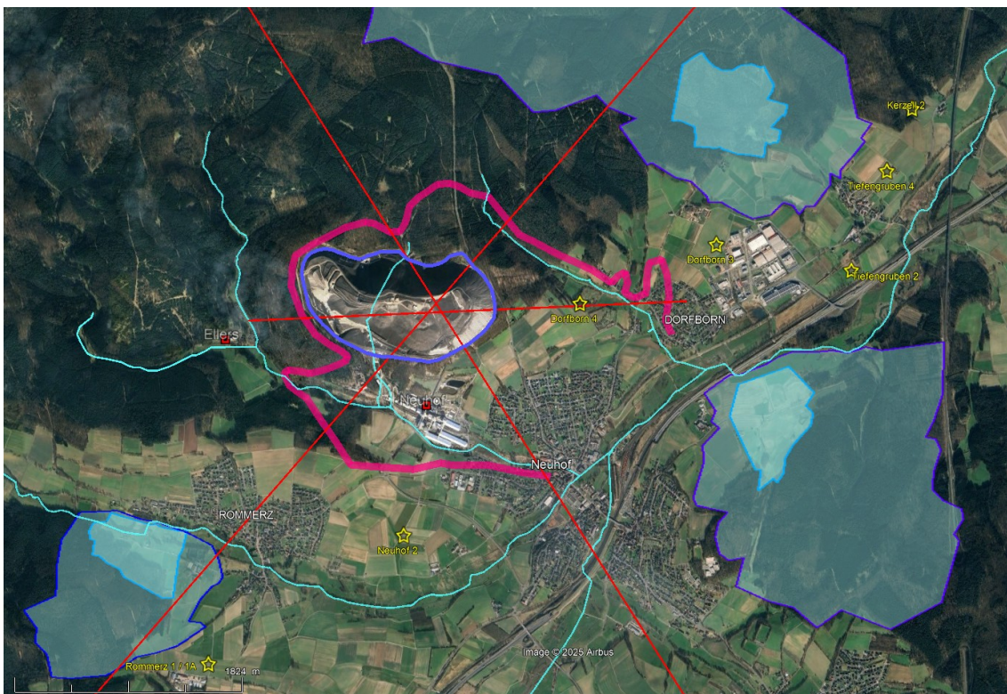
Abbildung 12 – Übersicht des zentralen Befliegungsgebiets mit SkyTEM-Messungen. Die drei roten Profillinien markieren die Lage entsprechender Schnitt-Darstellungen in Fugro (2014). Die Wasserschutz-zonen II und III benachbarter Trinkwassergewinnungsanlagen sind ebenfalls eingetragen.
